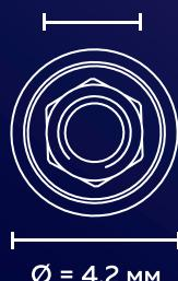
Скуловые имплантаты Touareg OS Zygomatic разработаны для немедленной нагрузки, что позволяет фиксировать ортопедическую конструкцию сразу после установки. Имплантат проходит через альвеолярный отросток верхней челюсти и закрепляется в скуловой кости. Его конусообразная форма с полированным телом, двухзаходной резьбой (2x1.2 мм) и скругленной верхушкой (3 мм) способствует эффекту самонарезания и уплотнения кости.
